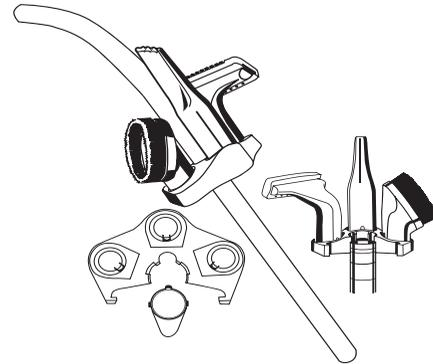
**부착 캐디 (연장관):** 부착 캐디는 먼지떨이 브러시, 가구 청소용구, 좁은 구석청소용구를 한군데 보관하는 기구다. 이것은 하우스 양 옆에 있는 걸이로 하우스 앞으로 밀어 넣음으로써 전력원 앞에 부착한다(그림참조). 캐디를 밑으로 밀면서 제 위치에 잠근다. 청소 용구들은 캐디의 걸이에 걸어서 보관한다. 걸쇠 단추를 눌러서 쏜다. 부착 캐디는 또한 어떠한 연장관 끝이라도 조립될 수 있다. 연장관 끝의 탭을 캐디 안쪽 구멍에 나열한다. 캐디가 연장관 끝에 잠길 때까지 연장관 쪽으로 누른다. 빼내는 법: 연장 관을 해체한 다음, 연장관 앞쪽으로부터 캐디를 비틀어 빼어낸다.
