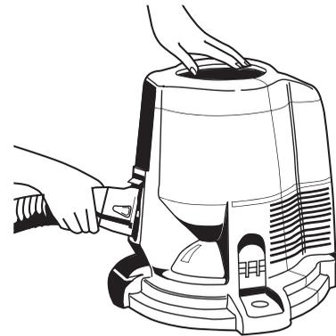
**4 전기코드를 벽의 소켓에 연결합니다. 스위치를 앞쪽으로 "고속"표시(>>)쪽으로 누릅니다. 일반적인 소제를 위한 작동은 이 표시에 맞추십시오. Rainbow 을 끄려면, 스위치를 "꺼짐" 표시(0)로 누릅니다.**
